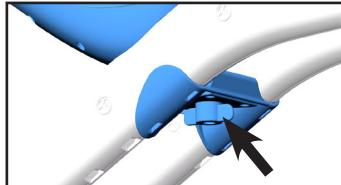
2. Faites pivoter les deux segments du châssis à 180°. Vous observerez que les segments du châssis sont articulés autour du guidon.
