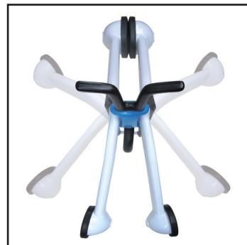
3. Montieren Sie den Sitz wieder. Dadurch werden beide Rahmenbeine an der anderen Seite des Lenkers befestigt. Sie werden feststellen, dass sich an der Unterseite des Rahmenbeines Befestigungslöcher für die Sitzmontage befinden.
