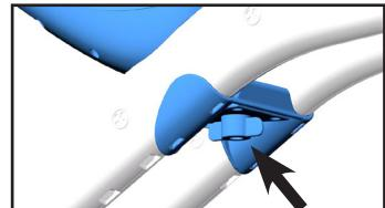
2. Drehen Sie beide Rahmenbeine um 180° auf die andere Seite. Sie werden feststellen, dass die Rahmenbeine an Scharnieren am Lenker aufgehängt sind.
