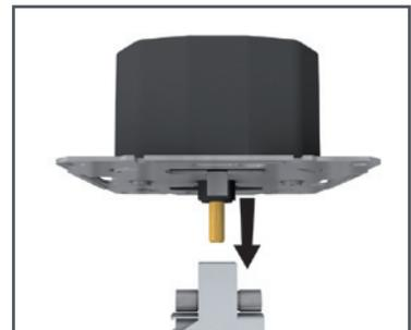
Extraire le porte-fusible à l'aide d'un tournevis. Retirer le fusible grillé et le remplacer par un fusible de rechange
