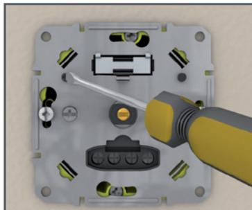
Allumer le variateur. Réduire la luminosité le plus possible en utilisant le bouton rotatif. Régler la luminosité minimale en utilisant la vis de serrage.
