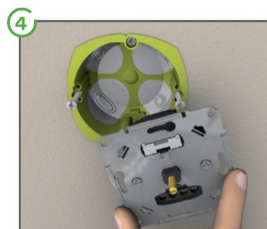
4 Pour utiliser la fixation par vis, enlever les griffes. Dévisser légèrement les 2 vis de la boîte d'encastrement pour permettre le passage des 2 têtes de vis. Mettre à niveau l'appareil et le fixer.
