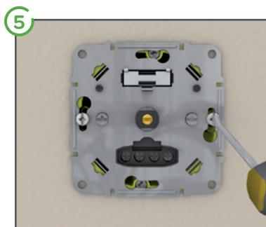
5 Mettre à niveau l'appareil et le fixe dans la boîte d'encastrement
