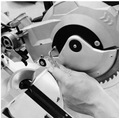
Dévisser la vis du capot d'accès aux vis de fixation de la lame (10).
