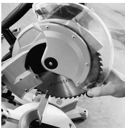
Tirer le capot de protection de lame inférieure (mobile) (4) vers le bas et le faire basculer vers le haut.
