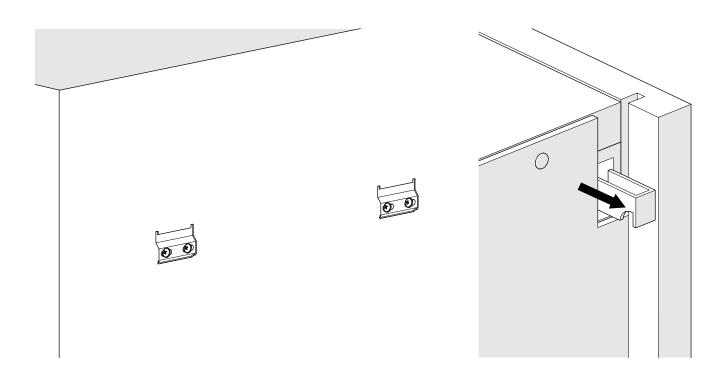
Venez positionner votre meuble de cuisine sur les attaches murales, et dans un second temps, régler la vis 1 pour rapprocher le meuble du mur et la vis 2 pour régler son horizontalité en vous servant du niveau à bulles en le posant sur le dessus du meuble.
