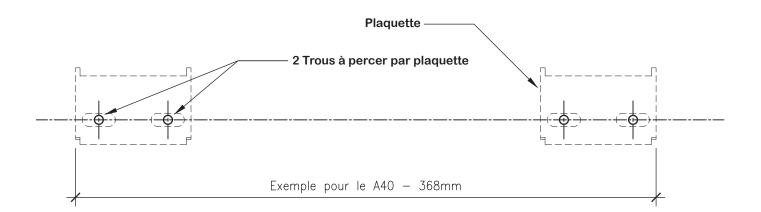
Percer tous les trous en utilisant une mèche adaptée à votre mur. Placer les chevilles dans les trous. Il ne faut pas qu'elles dépassent du mur.
