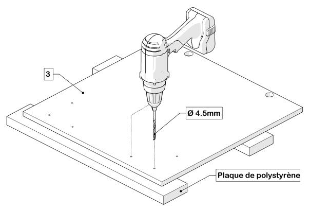
Vous pouvez vous servir du polystyrène se trouvant des les cartons d'emballage du meuble. Les pré-perçages vous permettent de choisir la position des poignées, horizontales ou verticales. Percer avec précaution pour ne pas endommager la laque de finition lors du débouchage.
